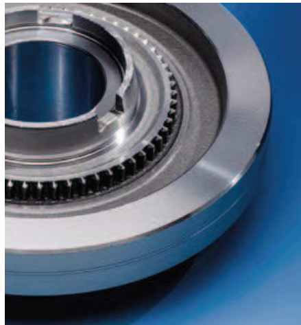
Zahnradrohling mit präzisionsgeschmiedeter Kuppelverzahnung. Vorteile sind die optimierte Auslegung der Verzahnung, die Integration von Nebenfunktionselementen sowie eine optimale Gestaltung der Zahnfußkontur (Bild: Sona BLW Präzisionsschmiede)
