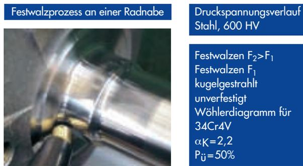
Bild 17: Festwalzen von Oberflächen
